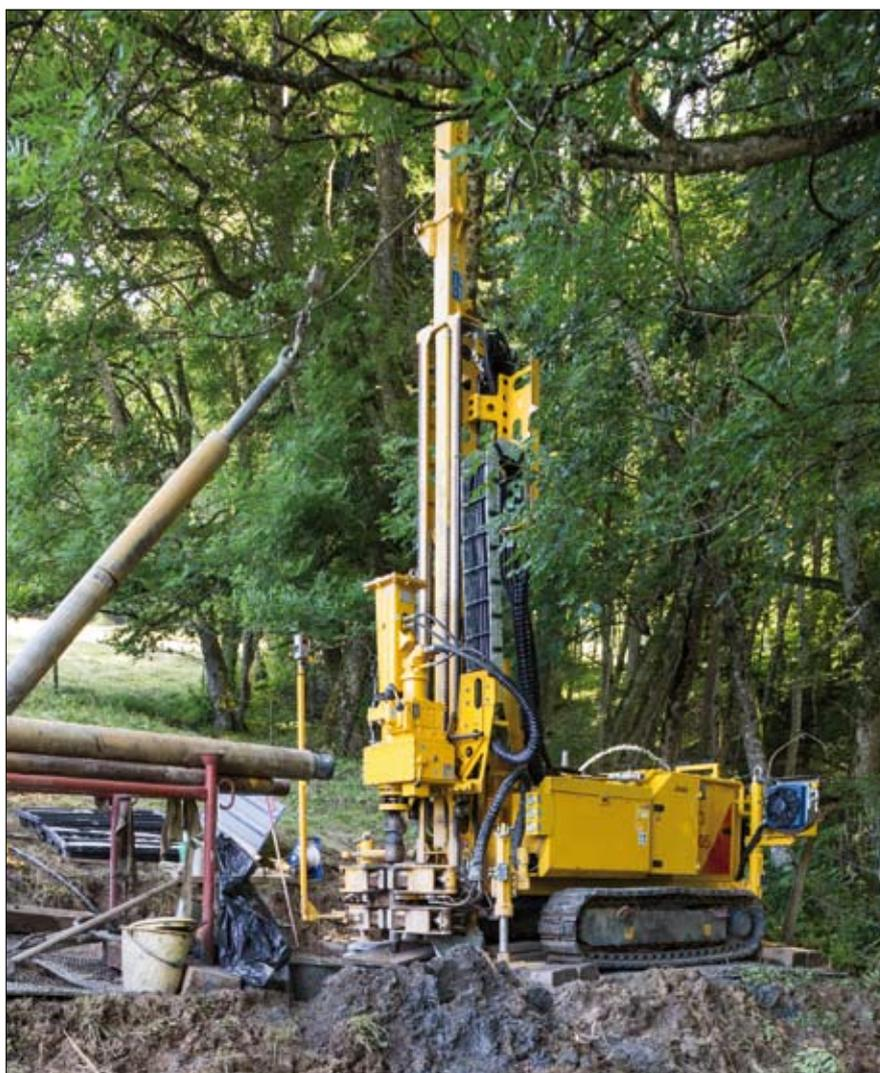
La linea GEO (nella foto, il modello Geo 305) comprende macchine che vanno dalle 1,5 alle 20 t, studiate per un ampio spettro di lavorazioni legate alle indagini geognostiche, alle ricerche e attività di monitoraggio ambientale e ai pozzi acquiferi
