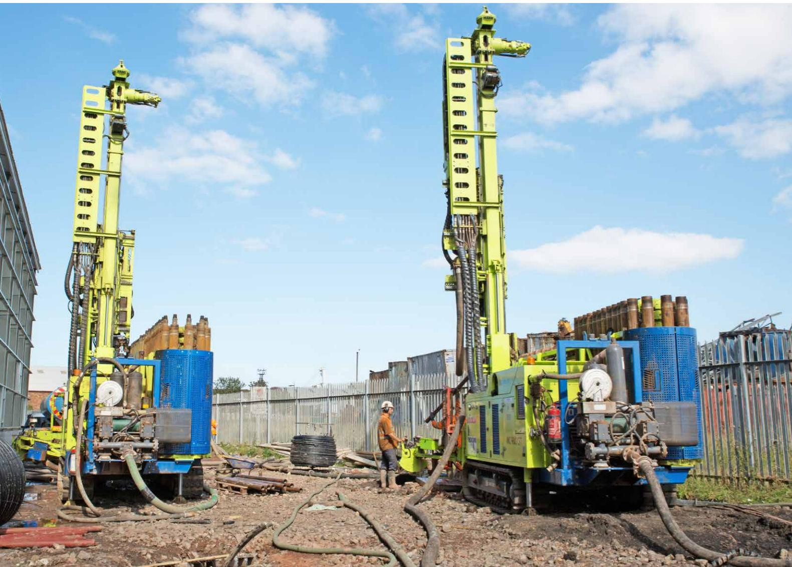
La serie GEO GT comprende un vasto ventaglio di modelli, nella categoria di peso dalle 9 alle 30 t, installati su carro cingolato, progettati per la perforazione di pozzi geotermici e altre applicazioni che necessitano di una stabilizzazione del foro tramite rivestimenti.
