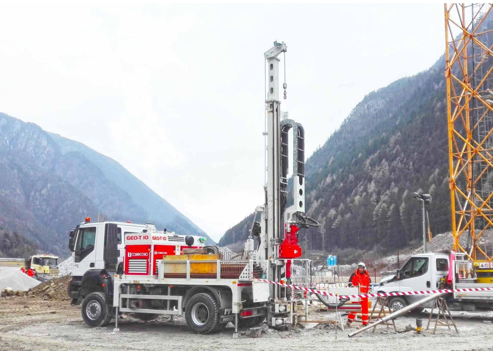
Линия GEO также включает в себя серию буровых установок, смонтированных на автомобильной базе, быстро мобилизующихся и подготавливающихся к рабочему процессу, идеально подходящих для геологоразведочных работ в сложных условиях окружающей среды, на отдаленных территориях и / или на неровной местности, а также для бурения водозаборных скважин.
