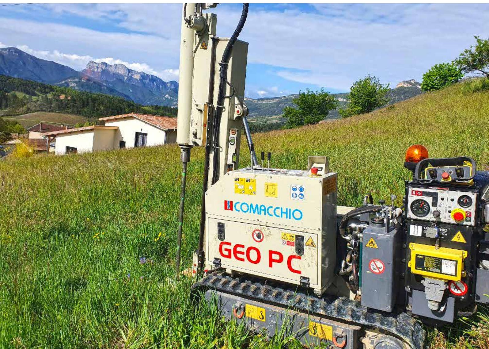
GEO PC - автоматический динамический пенетрометр, установленный на ходовой части с резиновыми гусеницами, используемый для отбора проб для лабораторного анализа, геотехнических испытаний SPT (Standard Penetration Test), DPH (Dynamic Heavy Probes) и DPSH-A (Dynamic Super Heavy Probes). Пенетрометр GEO PC может быть оснащен вращателем для бурения почвы на небольшие глубины.
