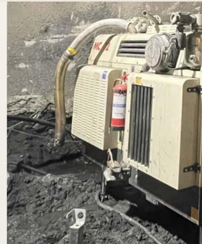
toni - Con questa attrezzatura le nostre maestranze possono eseguire sia le perforazioni a distruzione che le perforazioni carotate wireline. I carotaggi vengono eseguiti con una testa di rotazione Comacchio che garantisce una velocità fino a 550 rpm, mentre per le perforazioni a distruzione l'allestimento prevede un al-
