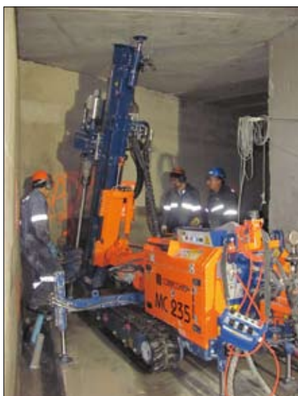
For the drilling operations contractor Pilotest Terratest chose a Comacchio drill rig MC 3 D with a separate power pack/Per le operazioni di perforazione l'impresa Pilotest Terratest ha scelto una perforatrice Comacchio MC 3 D con centrale idraulica separata
